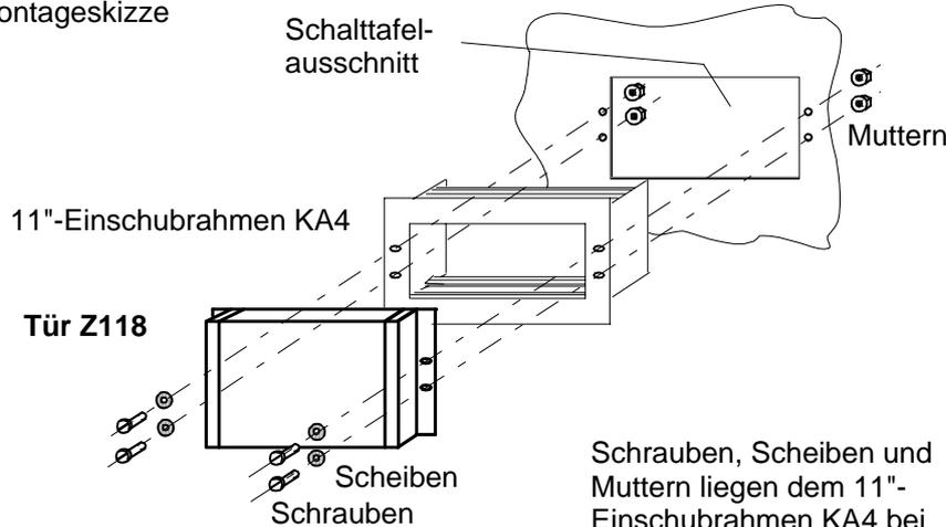
Schrauben, Scheiben und Muttern liegen dem 11"-Einschubrahmen KA4 bei
